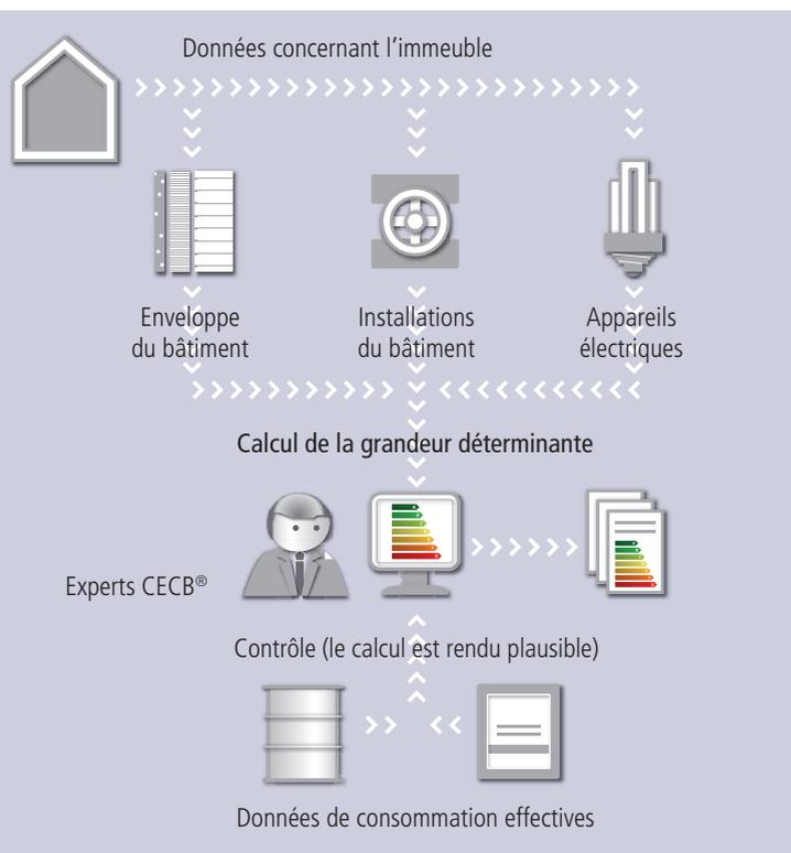
La méthode de calcul qui sous-tend le CECB® permet de comparer les données calculées de consommation énergétique d'un immeuble avec celles effectives. Il est nécessaire de recourir aux connaissances techniques d'un expert pour déterminer correctement les données relevant de la physique du bâtiment. Les données de consommation d'énergie effectivement « mesurées » servent uniquement à vérifier l'exactitude des calculs.
